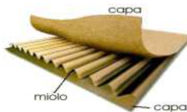
Figura 13 - Estrutura do Papelão Ondulado - Fonte: Site da ABRE
